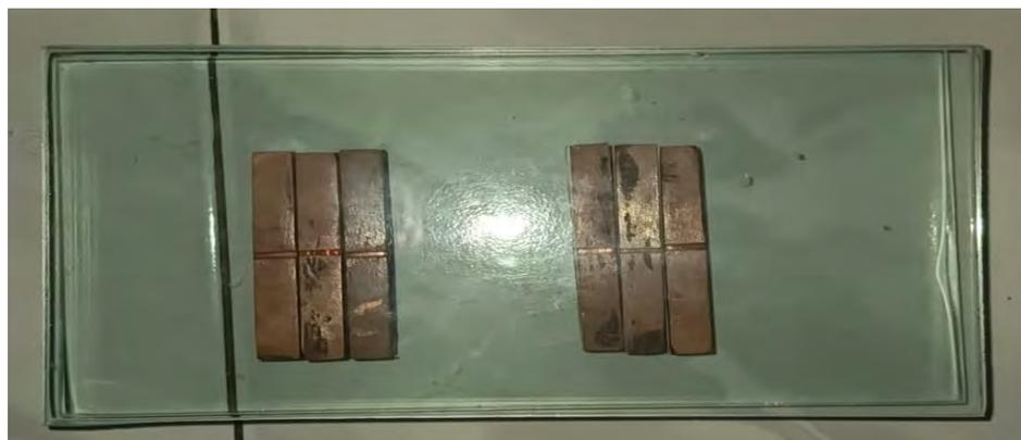
Gambar 3.21. Tampak atas spesimen yang telah digabung tetapi belum diberi beban plat
