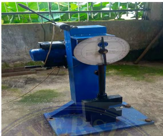
Gambar 3.24. Persiapan alat uji impak *charpy*
