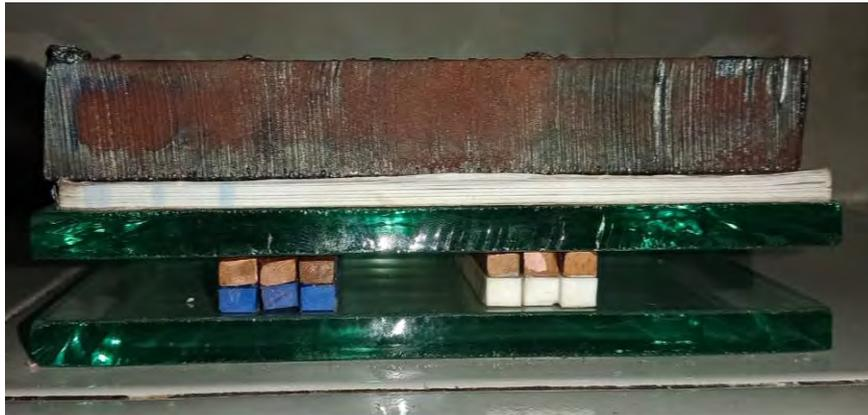
Gambar 3.22. Tampak samping spesimen yang diberi beban plat besi dengan berat 5 kg
