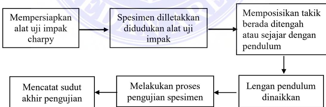
Gambar 3.23. Diagram alir proses pengujian
