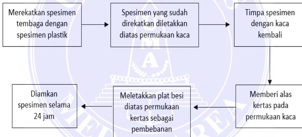
Gambar 3.20. Diagram alir penggabungan spesimen.
