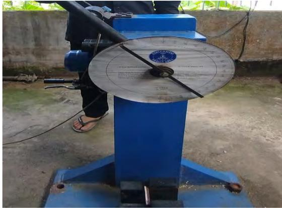
Gambar 3.27. Posisi lengan pendulum dinaikkan
