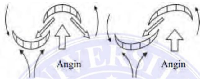
Gambar 2.7. Skema Aliran Angin Turbin Angin Savonius
