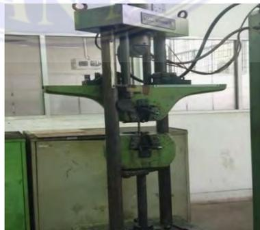
Gambar 3.3. Mesin Uji Tarik (*Tensile Testing Mechine*)
