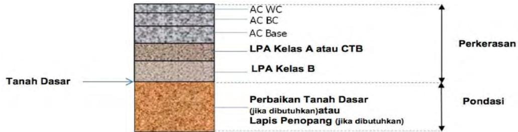
Gambar 2. Struktur Perkerasan Lentur pada Permukaan Tanah Asli
