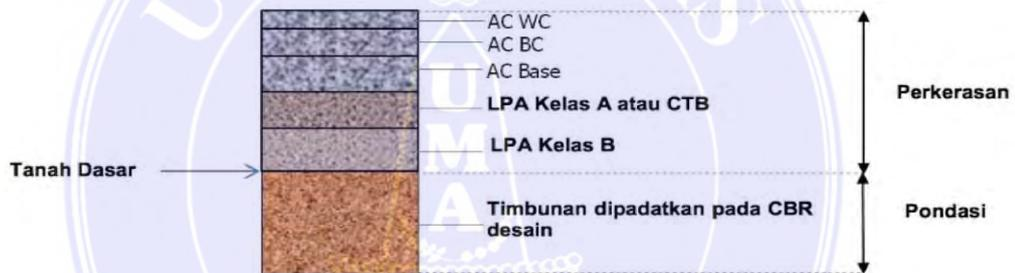
Gambar 3. Struktur Perkerasan Lentur pada Timbunan
