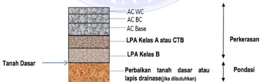
Gambar 4. Struktur Perkerasan Lentur pada Galian
