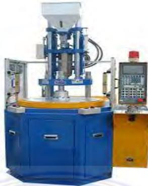
Gambar 2.10. *Ijection Molding* Vertikal [28]
