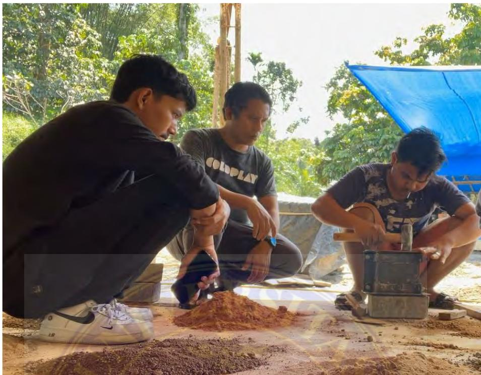
Gambar 5. 19 Sample cetakan Rammed Erath Wall
