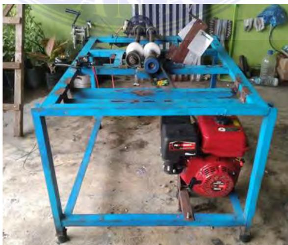
Gambar 3.6. Alat Uji Keausan Roda Gigi
