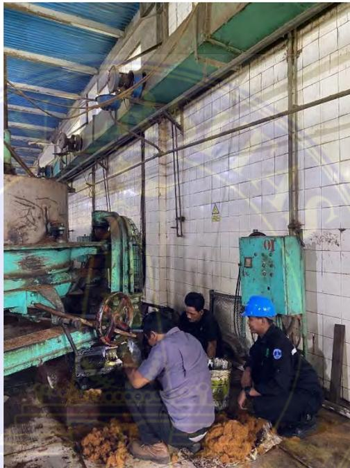
Gambar 3.38. Perawatan Mesin (*Open Top Roller*) OTR
