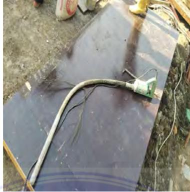
Gambar 3.3. *Beton Vibrator* (Data Lapangan, 2025)
