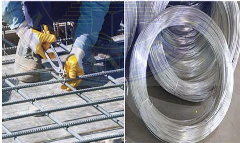
*Gambar 3 4 Tang Binding dan Kawat Beton*
