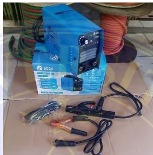
Gambar 3. 11 Trafo Las 450 Watt
