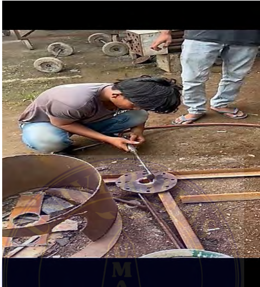
Lampiran 4 Proses Pembuatan Flange
