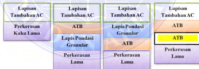
Gambar 3. Contoh Struktur Perkerasan Komposit dengan overlay AC diatas perkerasan beton semen portland ( James & Jameson, 2013 )
