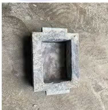
Gambar 3. 4 Cetakan Paving Block
