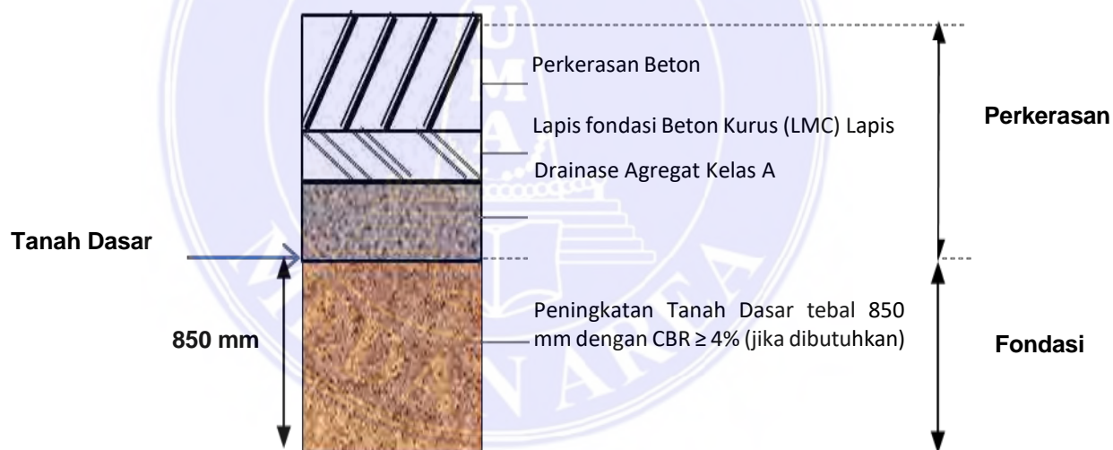
Gambar 4 Perkerasan pada galian (Bina Marga, 2017)
