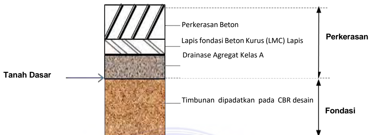
Gambar 3 Perkerasan pada timbunan (Bina Marga, 2017)
