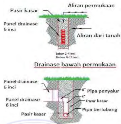
Gambar 2 Ilustrasi Drainase Bawah Permukaan. (Hidayat dkk, 2016)
