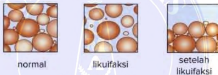
Gambar 8 Tanah Dalam Keadaan Normal, Likuifaksi dan Setelah Likuifaksi (S.,A. (Ega., 2020)
