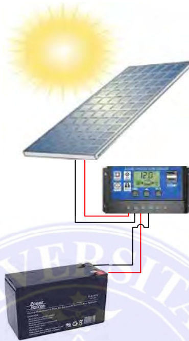
Gambar 3.5: Rangkaian komponen PLTS
