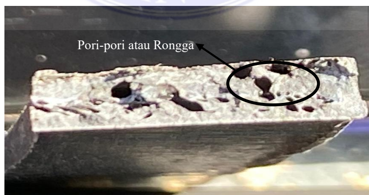
Gambar 4. 9. Hasil Spesimen PP 95%, KA 5% Setelah Pengujian Bending
