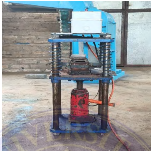
Gambar 3. 1. Mesin tekanan skala laboratorium
