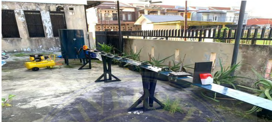
Gambar 4.9. proses pengujian alat uji impak batang kapasitas maksimum 10 bar
