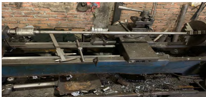
Gambar 4.6. Pembubutan Batang Striker
