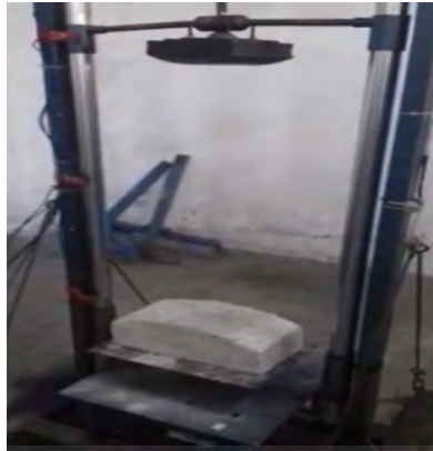
Gambar 2.27. Uji impak jatuh bebas ( Sumber: Pakpahan, G. 2022)
