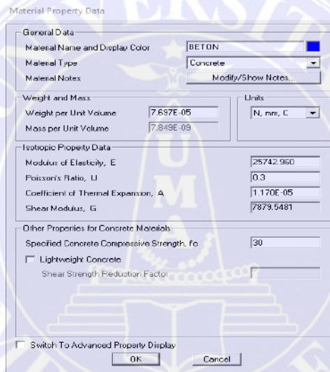
Gambar 7 Data Bahan dan Material Beton (SAP 2000 V14, 2025)
