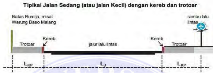
Gambar 6. Tipikal Jalan Dengan Kereb Tanpa Median (PKJI, 2023)
