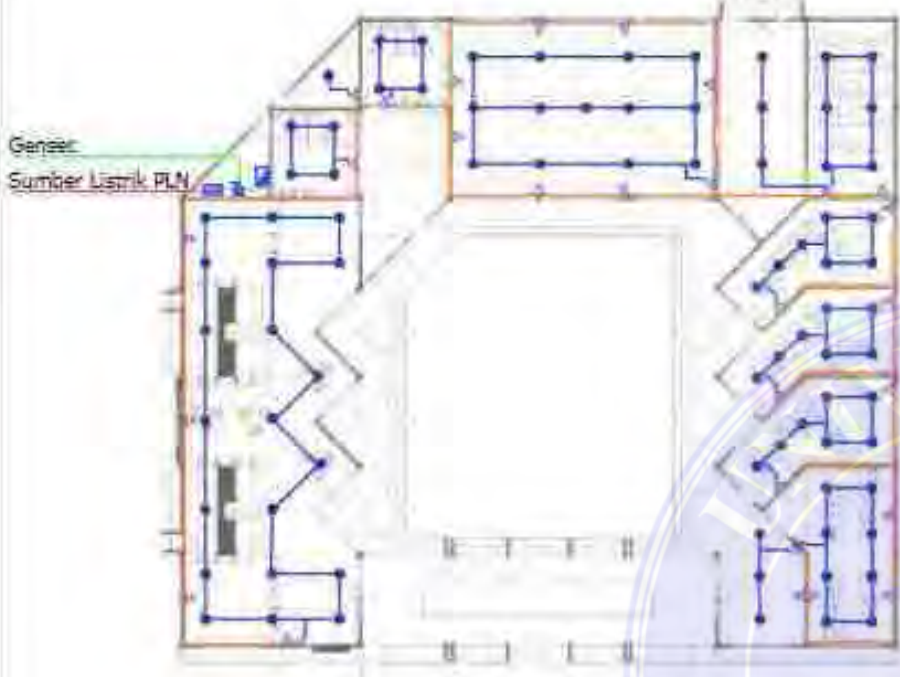
DENAH ELEKTRIKAL BANGUNAN EDUKASI 1:300
