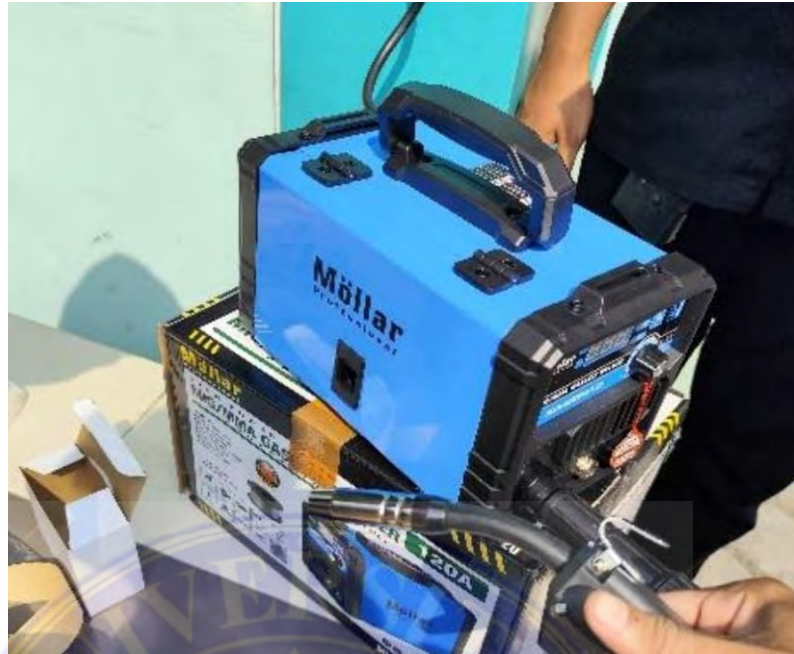
Gambar 2.12. Mesin Las MIG.
