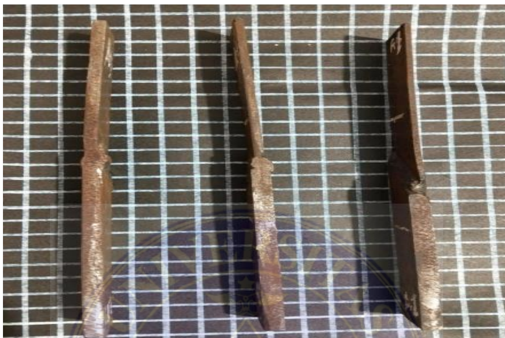
Lampiran 1. Spesimen pengelasan miring sebelum melakukan pengujian.
