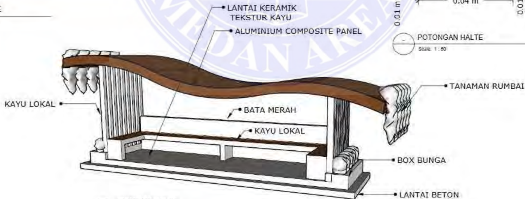
ISOMETRI HALTE Scale: 1 : 50
