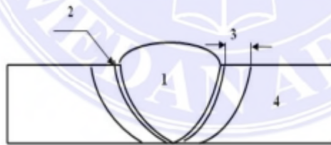
Gambar2.1 Daerah Pengaruh Panas Pada Pengelasan
