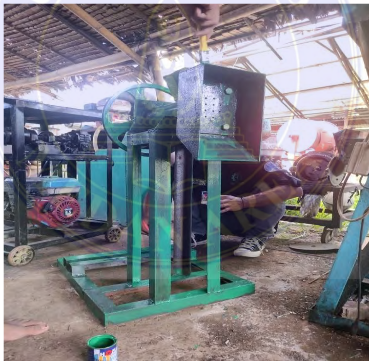
Lampiran 4. Pengecatan Mesi Mini Extruder.
