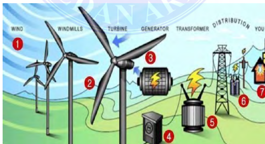
Gambar 2.1 Prinsip Kerja Energi Angin
