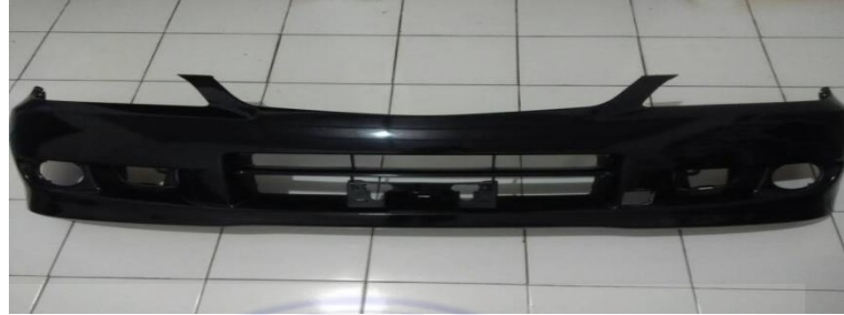
Gambar 2.17. Aplikasi Bahan Polipropilena pada Bumper Mobil
