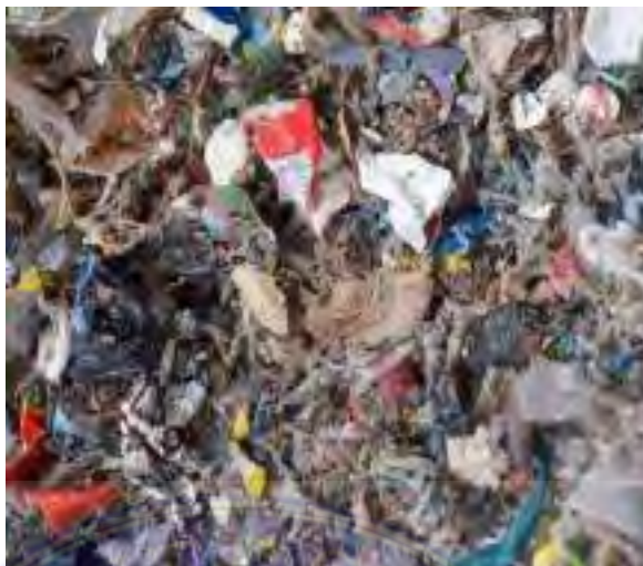
Gambar 2 22 Sampah campuran menjadi RDF
