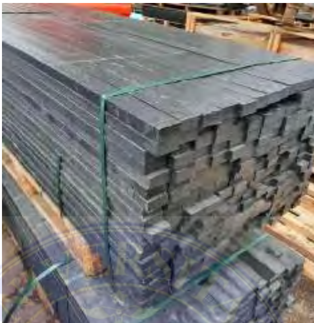
Gambar 2 23 Material Plastik Hasil Ekstrusi
