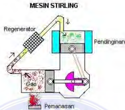
Gambar 2.10. Gas Kerja Mesin Stirling
