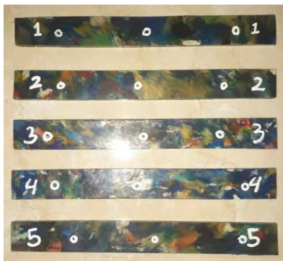
Gambar 4.2. Sampel uji kekerasan Plastic Sheet
