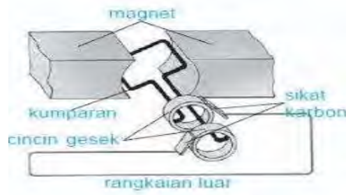
Gambar 2.10. Prinsip kerja generator
