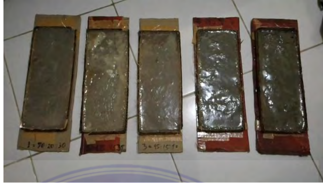
Gambar 3.4 Campuran yang sudah dituang kedalam cetakan.
