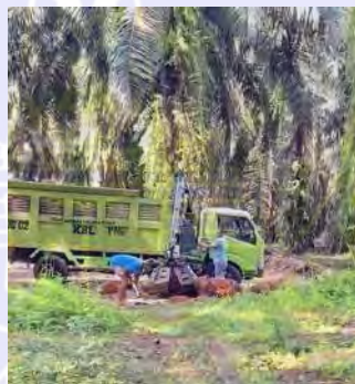
Gambar 34. Pengangkutan TBS menggunakan Dump Truck Grabbe
