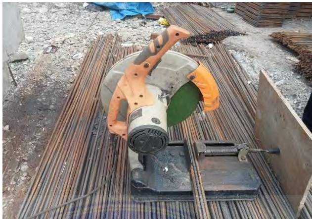
Gambar 3. 5 Mesin Cutting (Dokumentasi proyek 2025)
