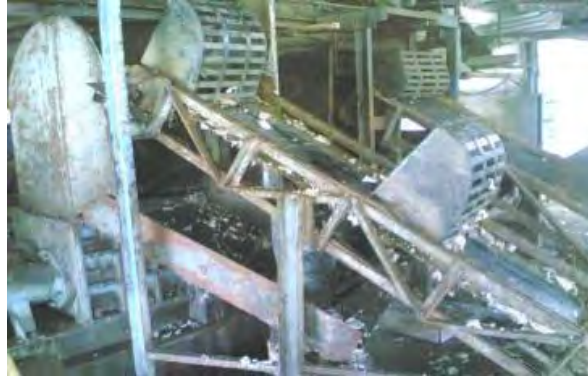
Gambar 3. 18 Mesin ini untuk memecahkan bongkahan getah
