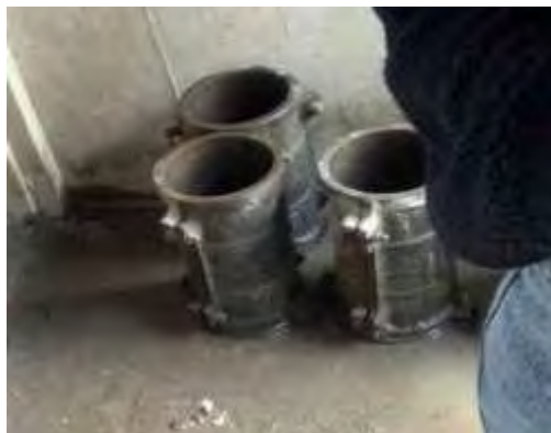
Gambar 3.26 Bekisting Silinder Sample (Dokumentasi Proyek)
