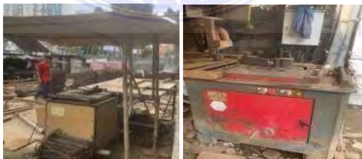
Gambar 3.15 Bar Bender (Dokumentasi Proyek)
