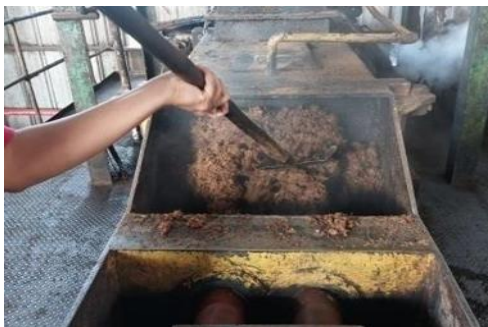
Gambar 3. 93 Pengambilan Sampel di Screw Press
