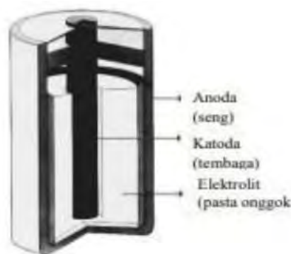
Gambar 2. 1 Baterai dan Komponen – Komponennya
