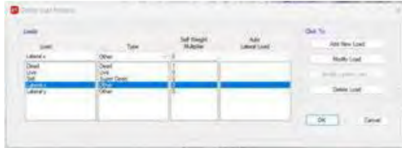
Gambar 37 Define Load Pattern Lateral X dan Y (ETABS V18, 2025)
