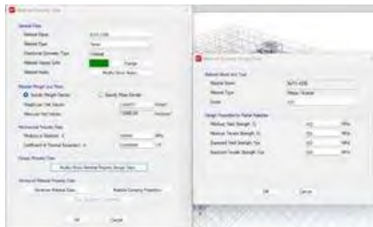
Gambar 14 Tampilan Add Material Property Rebar (ETABS V18, 2025)
