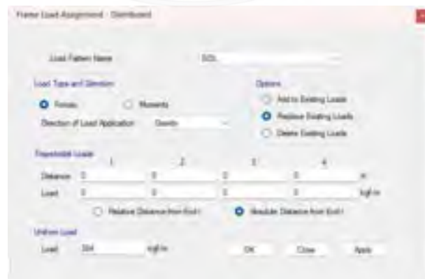
Gambar 29 Input Beban Mati Tambahan Pada Balok
