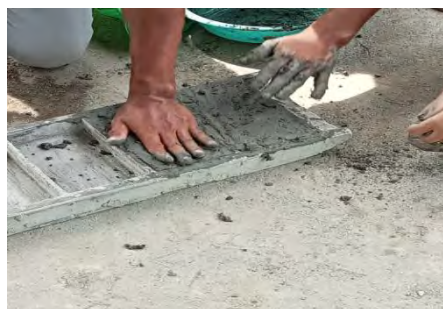
Gambar 10 Proses Pencetakan Bata
