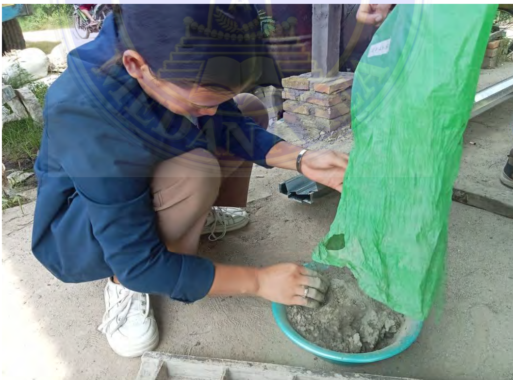
Lampiran 2. Pencampuran Fly Ash & Tanah Liat
