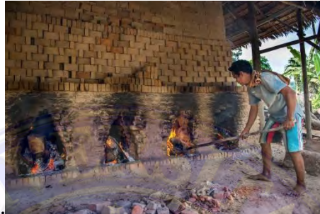
Gambar 1. Proses Pembakaran Bata Merah
