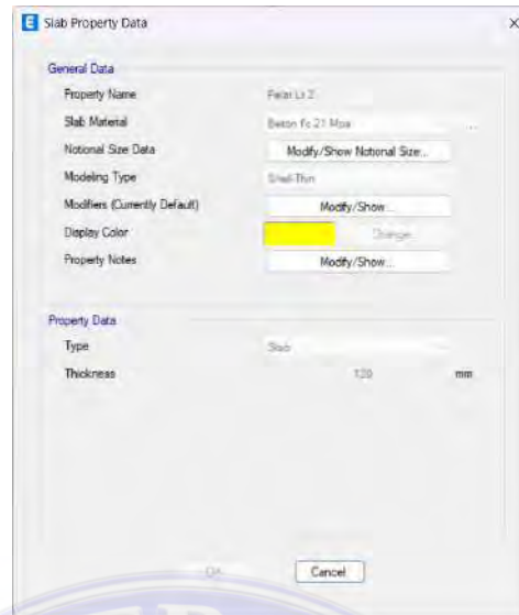
Gambar 11. Data Penampang Pelat Lantai ( ETABS V18, 2025)
