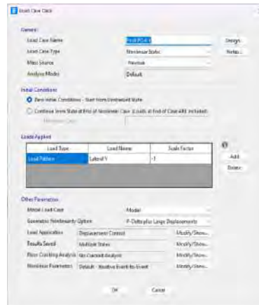
Gambar 36. Input Static Nonlinier Final POA Y (ETABS V22, 2025)
