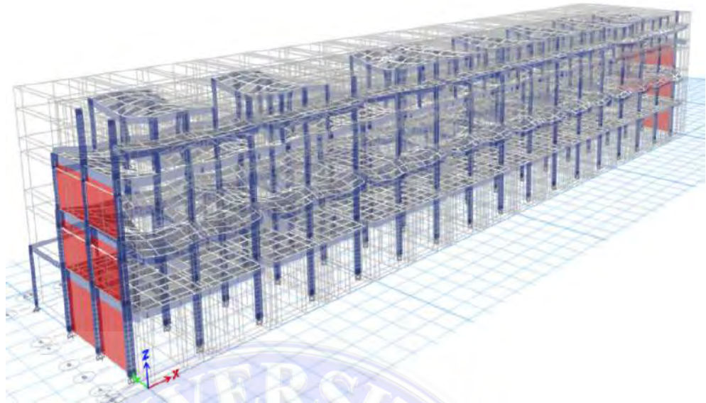
Gambar 17. Pemodelan sesudah di Run menggunakan Shear Wall ( ETABS V22, 2025)
