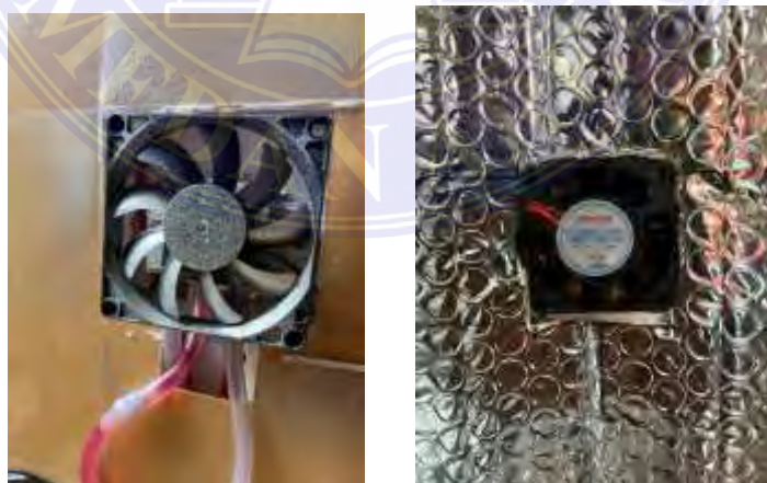
Gambar 3. 6 Kipas, a). kipas sisi panas. b). kipas sisi dingin
