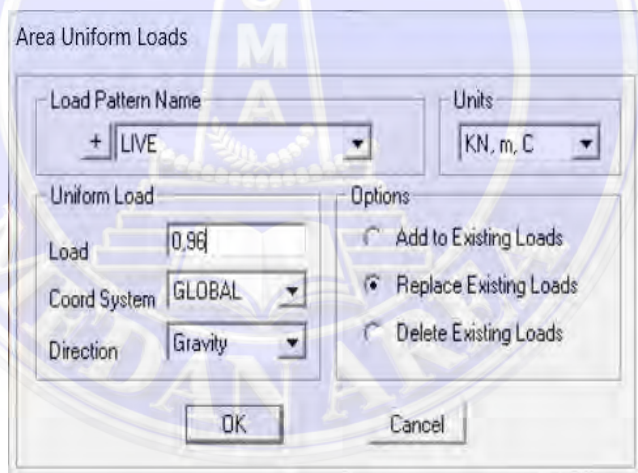
Gambar 18. Input Beban Hidup Pelat Atap ( SAP2000 V14, 2026)
