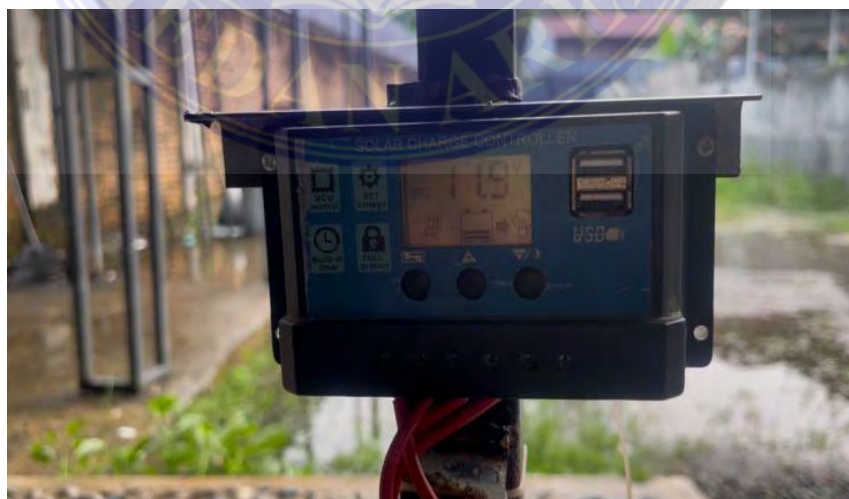
Gambar 2: Tampilan monitoring data yang masuk pada SCC.
