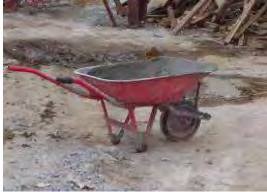
Gambar 3.15 Kereta Sorong (Dokumentasi Proyek, 2025)
