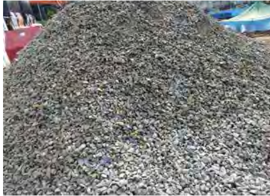
Gambar 3.3 Agregat kasar (Dokumentasi Proyek, 2025)
