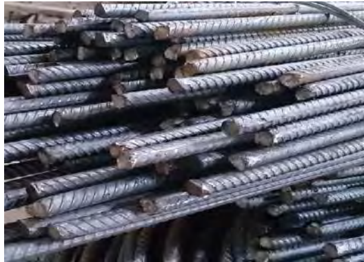
Gambar 3.5 Besi D10 (Dokumentasi Proyek, 2025)
